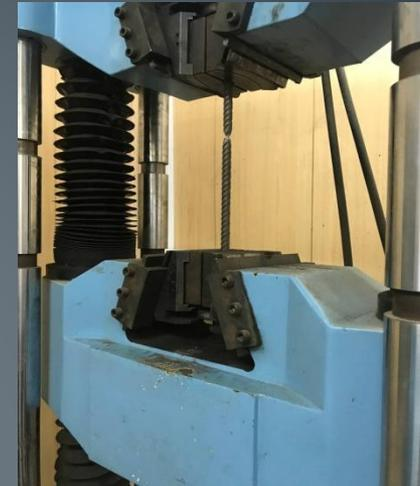
Steel tensile test
